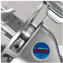
Espace remarquable entre la lame et le corps de la machine
