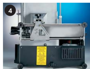
1 - Protège-main en plexiglass 2 - Grip sur le bouton de presse de la viande 3 - Micro-interrupteur sur le protège-lame 4 - Plaque de protection sous le moteur
